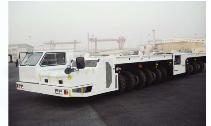
ノンスリップ制御付きキャリヤ(未舗装傾斜試験 80t 19%)
