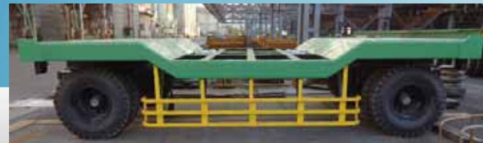
2軸 8輪フルトレーラー 2-axle 8-wheel full-trailer
