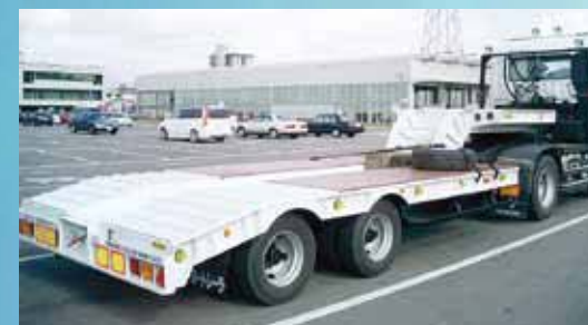
2軸 8輪重機運搬用トレーラー (軽量、シングルトラクター連結可) 2-axle 8-wheel heavy-duty machinery transport trailer (possible to couple light-duty single tractor)
