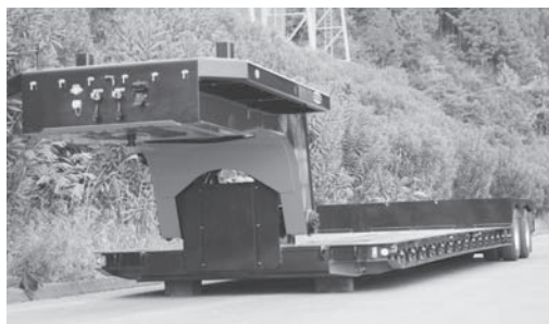
60t 3轴 12轮风力塔运输挂车 （带遥控转向装置，可伸缩）
