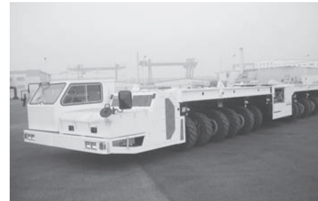
120t 具有防滑控制功能的自走车（不良路况下的倾斜试验，80t：19%）
